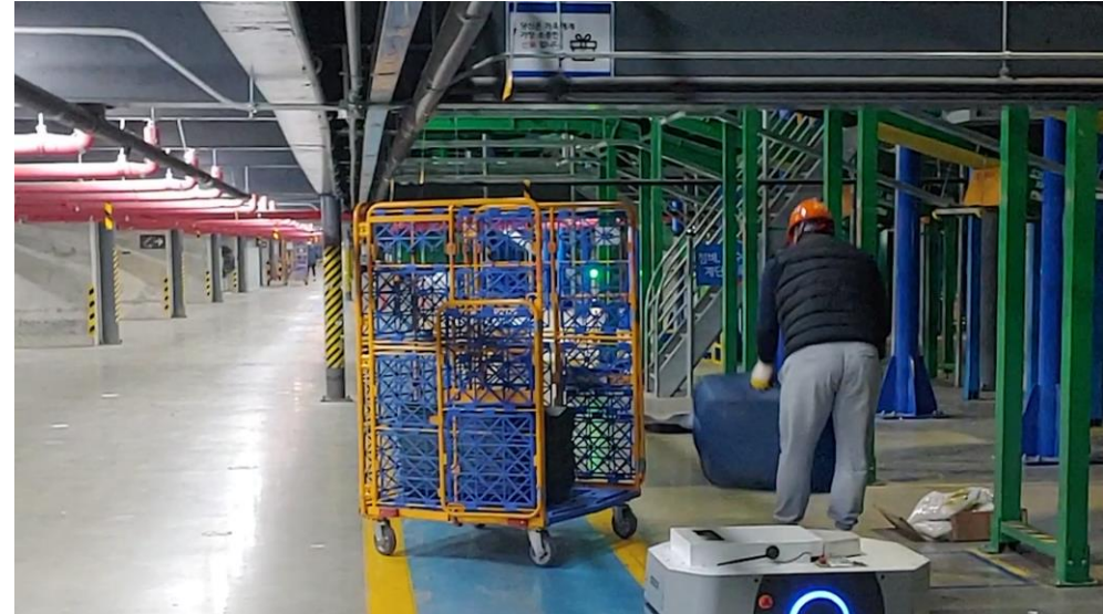
이형화물 받침 회수 자동화 (LIDAR SLAM 자율주행로봇)
